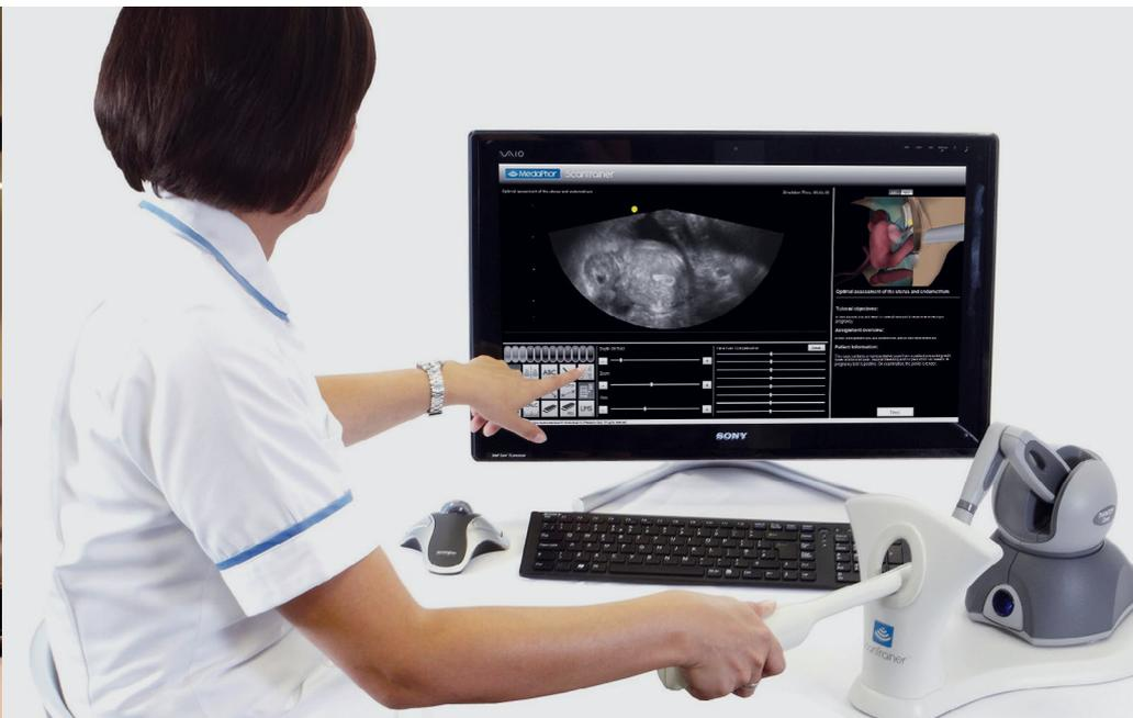
Geomagic がお届けするハプティック デバイスで、本物の 3 次元インプットにフォース フィードバックを提供します。研究、商用アプリケーションとして、また、Geomagic® Freeform® や Geomagic® Claytools® 3Dモデリング システムに触覚デバイス (Geomagic® Touch™ X・Geomagic® Touch™) を組み込みます。Geomagic デバイスでは、3D 空間位置 (x, y, z座標) とスタイラスペンの方向 (ピッチ、ロール、ヨー) を正確に制御できます。デバイスはモーターを使って、ユーザーの手に押し返される力を生成し、仮想オブジェクトに触るタッチと相互作用をシミュレートします。3DOF (自由度) および6DOFモデルの 2 種類があります。
