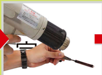
オープンやヒートガンなどで5分から30分乾燥・焼き付けを行い完成です。完成度を高めるためには、乾燥器などで150℃-30分乾燥する事をお勧め致します。
