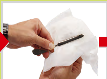
メッキしたい製品をアルコールなどで、シッカリと汚れと油脂分を取り除き綺麗にします。※完成度を高めるためには、脱脂を行って下さい。
