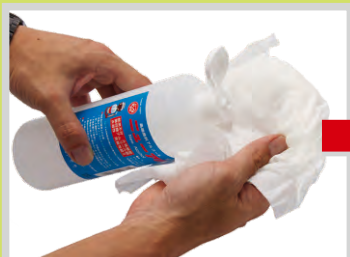
メッキしたい製品をアルコールなどで、シッカリと汚れと油脂分を取り除き綺麗にします。※完成度を高めるためには、脱脂を行って下さい。
