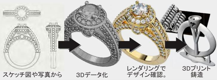
スケッチ図や写真から 3Dデータ化 レンダリングでデザイン確認。 3Dプリント 鋳造
